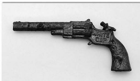
科捜研によるクリーニング後の状態 (錆がなくなり細部の形状や文字が鮮明に)
